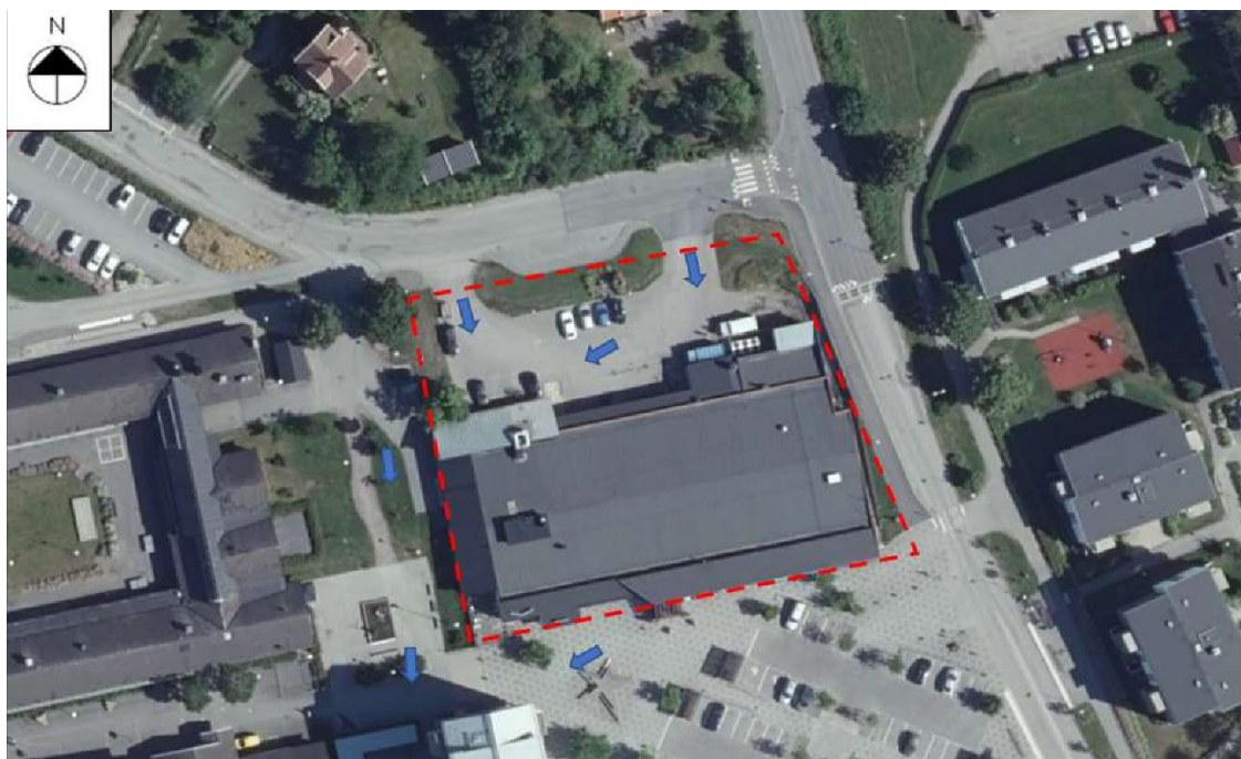
Figur 18. Blåa pilar visar befintlig yttlig avrinning inom och angränsande till planområdet. Norconsult AB.
