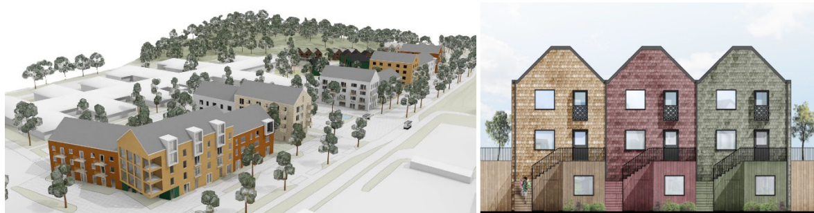
Till vänster; Vy från sydväst med högre bebyggelse längs Stensundsvägen och Tomtaklintgatan. Till höger; Radhus ovan garage. Entrén mot gårdsgatan nås via en trappa. Trappan ligger i anslutning till ett förråd med ovanliggande terrass.
