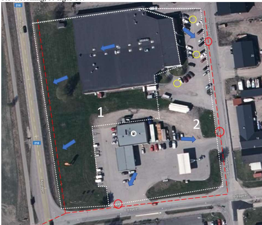
Figur 17: Beskrivning av den befintliga avrinningen med avrinningsområden där blå pilar motsvarar förväntad avrinningsriktning, röd linje - dagvattenledningar, röda cirklar – dagvattenbrunnar, gula cirklar - brunnar som inte syns på ledningsunderlag (Dagvattenutredning, 2020-09-14, Norconsult).
