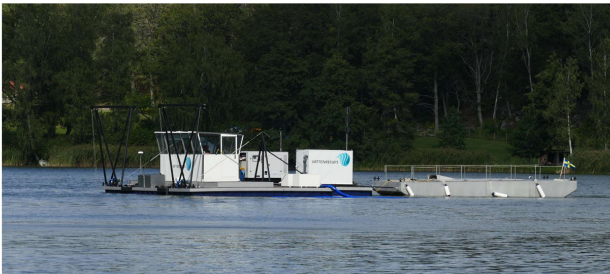
Figur 4-13. Aluminiumbehandling av sjöbotten från specialbyggd båt. Foto: Sollentuna kommun
