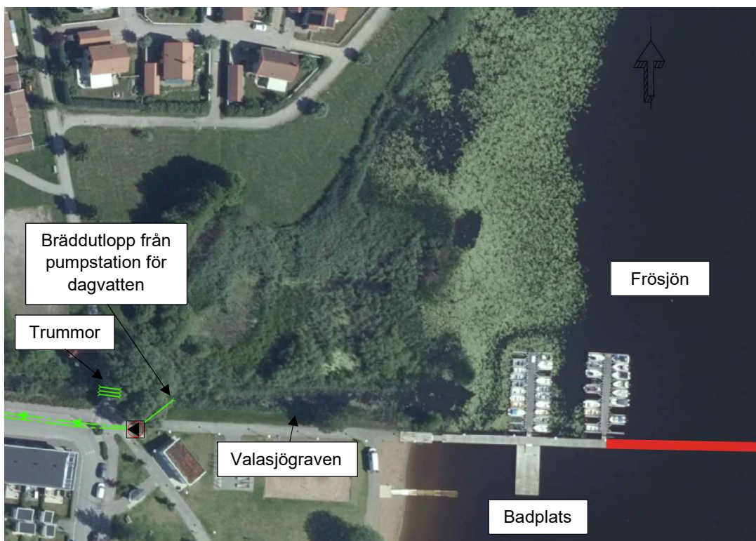
Figur 4-2. Förslag på förlängning av brygga (i rött) med skärm undertill för att styra vattnet från Valasjögraven längre bort från badplatsen.
