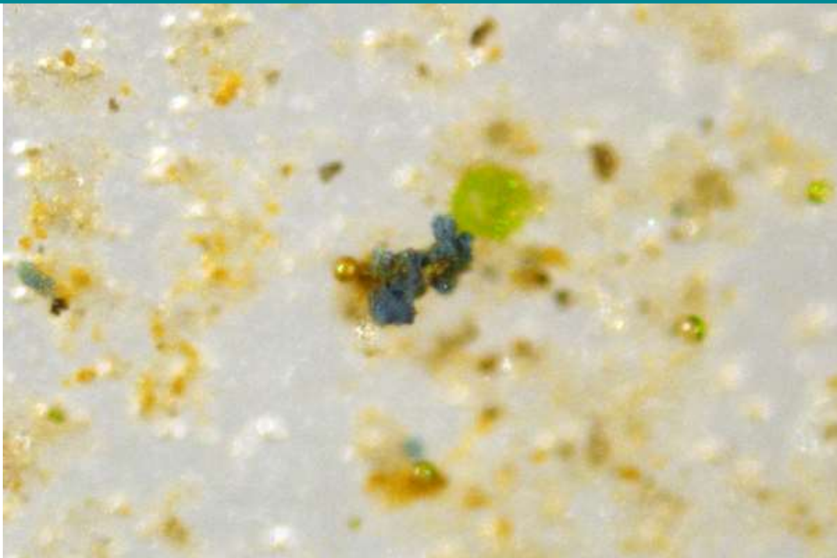
Figur 7. Oidentifierad blå partikel funnen i vattenprovet från Björnlunda ARV. Partikeln på bilden är ca 100µm. Storleken på partiklarna på 10 µm-filtret varierade mellan ca 10-100µm. Antalet partiklar uppskattades till ca 25000 per dm 3 .
