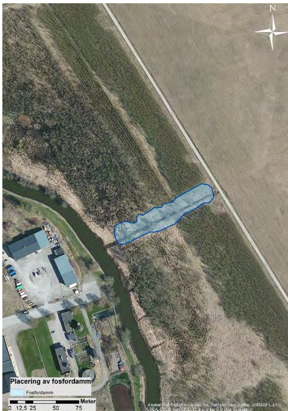
Figur 137. Förslag på placering och utformning för hur en våtmark/fosforfälla skulle kunna anläggas i det täckdike som mynnar i Sigtunaån och som för med sig en stor mängd sediment.
