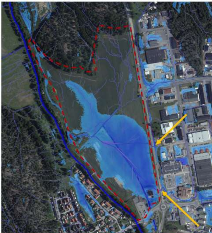
Ytliga rinnvägar och lågpunkter där vatten ansamlas vid 101 mm nederbörd. Gula pilar visar inflöde från områden i öst. Bild: Ramboll.
