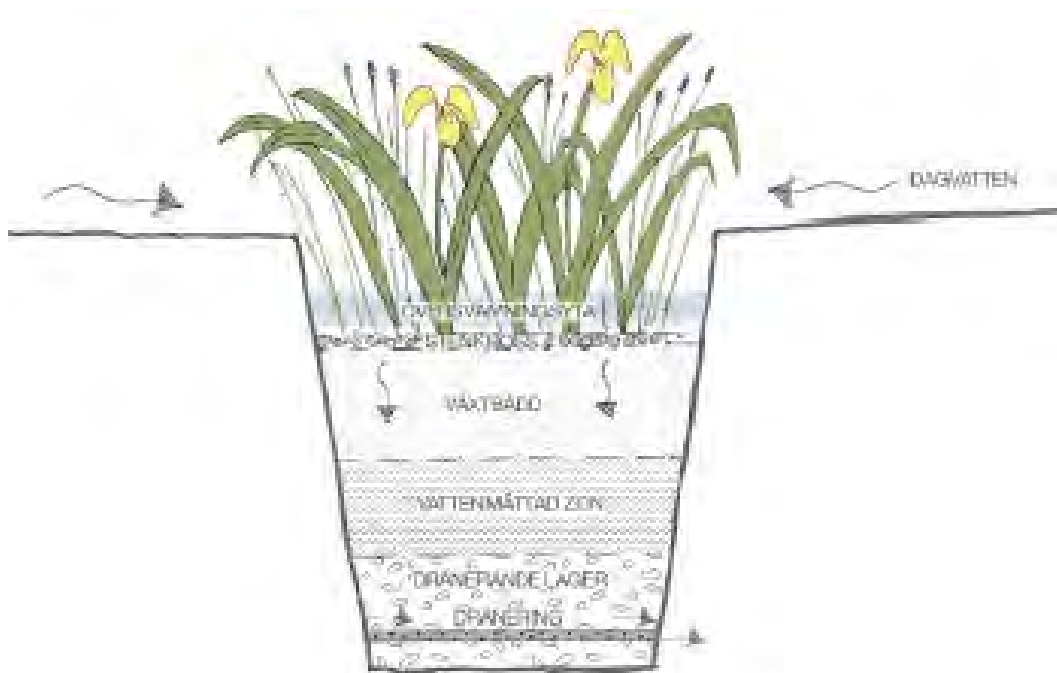
Principskiss för utformning av regnbädd (Norconsult 2022).
