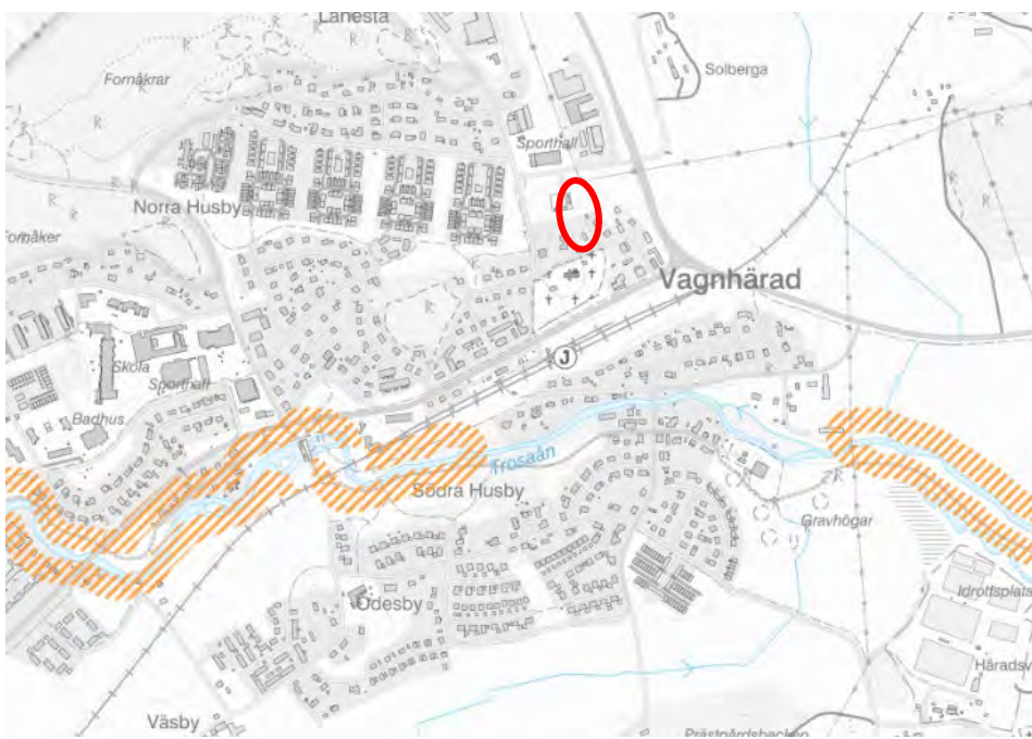
Utsnitt från SGU:s kartunderlag som visar förutsättningar för skred i finkornig jordart i strandnära områden längs med Trosaån.
