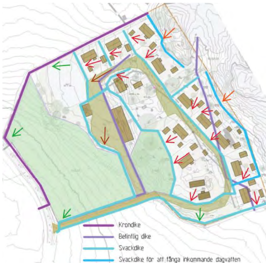
Bild som visar systemlösning med svackdiken. Orange pilar visar flödesriktningen från högre skogspartiet, röda pilar flödesriktningen inom tomtmark och gröna pilar flödesriktningen från parkmark och hästhage. Bildkälla: Structor.
