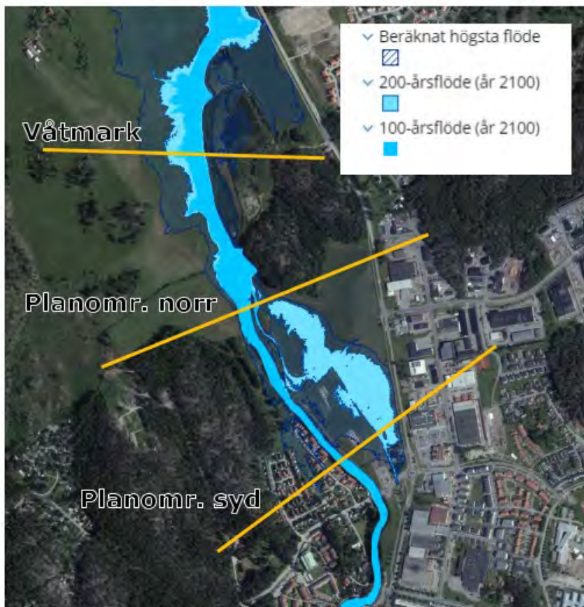
Beräknade vattennivåer i Trosaån enligt MSB:s flödescenarier med klimatanpassning. BHF anger det beräknade högsta flödet. Bild: Ramboll.
