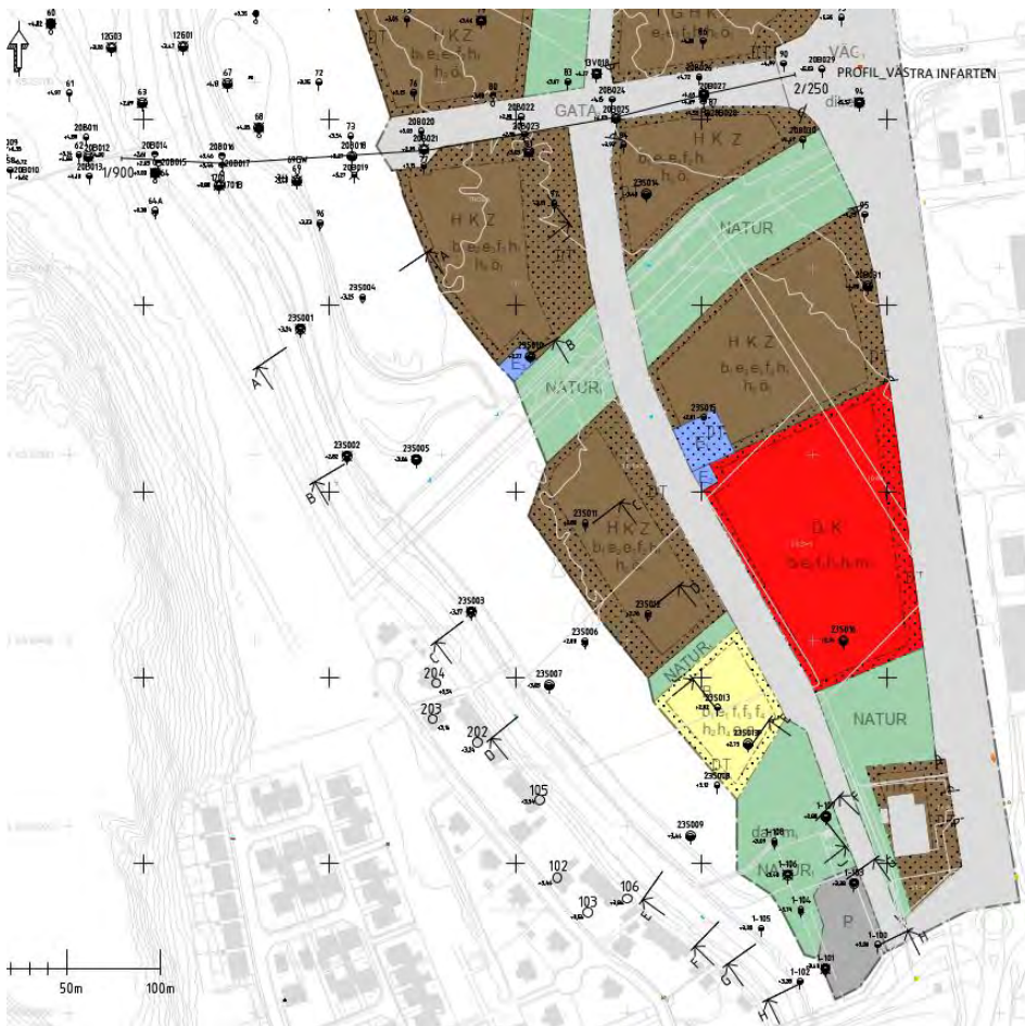
Figur 7 Äldre och nya undersökningspunkter samt beräkningssektioner för stabilitet inom planområdet och mot Trosaån [7].
