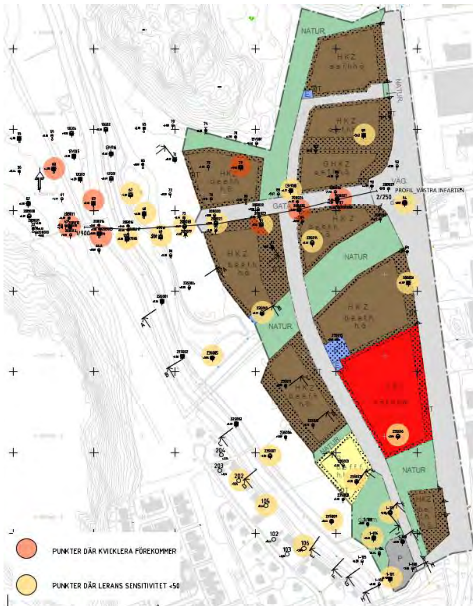
Figur 22. Röda punkter markerar där kvicklera förekommer, medan gula punkter visar områden där lerans sensitivitet är lägre än 50, det vill säga där det inte är kvicklera. Punkt 81 är både gul och röd, se förklaring i texten. Det bör noteras att förstärkning med inblandningspelare planeras inom planområdet för att bland annat motverka framtida sättningar, vilket kommer att förbättra lerans egenskaper.
